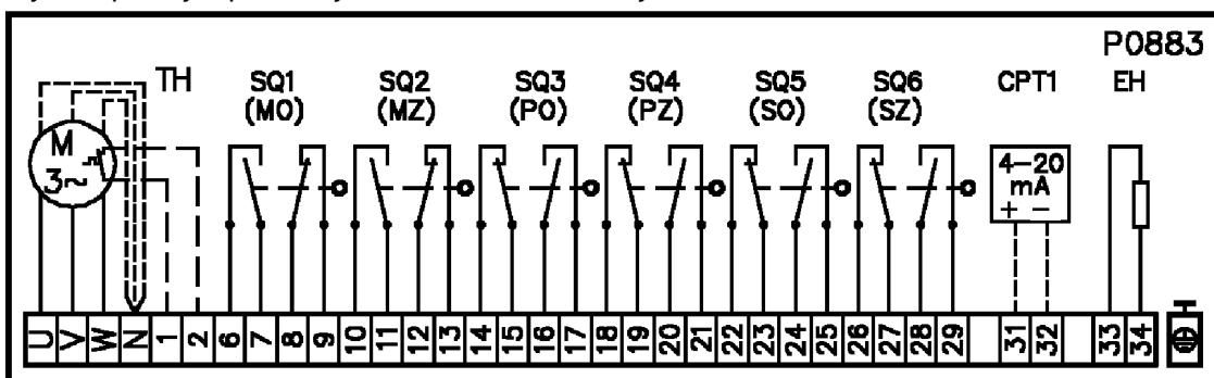
Vysílač polohy – proudový 4 – 20 mA s napájecím zdrojem
